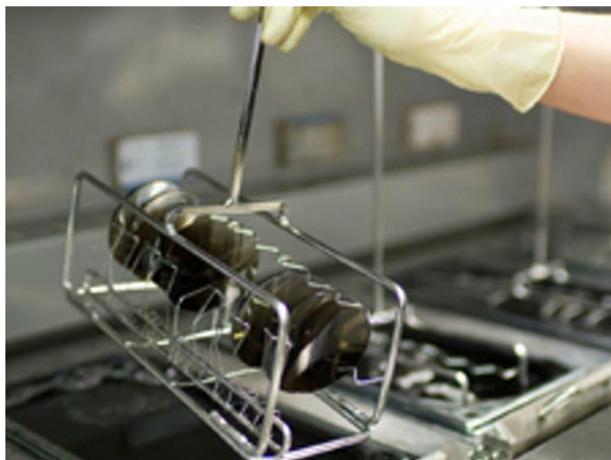
Le lenti con filtri speciali di ZEISS vengono colorate in un bagno ad immersione speciale
